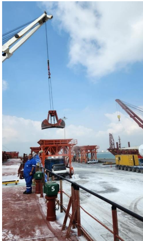
Gambar 4. Grab Proses Peletakan Cargo Soda Ash pada Hopper.
