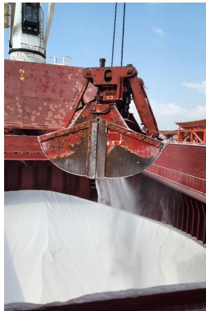
Gambar 3. Proses Pengambilan Cargo Soda Ash dengan Grab
