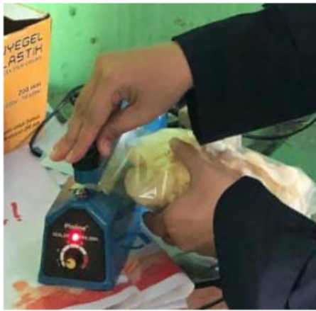
2.e Proses Segel Menggunakan Alat Press 2.f Hasil Segel menggunakan Alat Press
