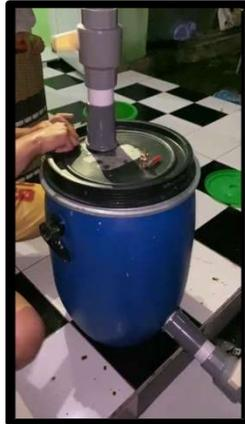
**Gambar 2.** Alat Digester dalam Pembuatan Pupuk Organik Padat dari Kotoran Sapi
