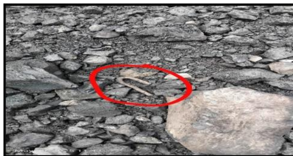
Gambar 3. Kontaminasi Material Asing pada Tumpukan Batubara di Area Stock ROM.
