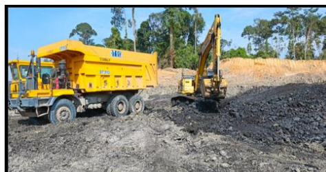
Gambar 7. Aktivitas Loading dan Hauling Batubara pada Area Tambang.
