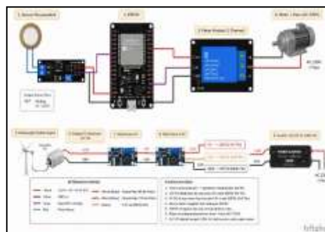
Gambar 4. Wiring Diagram (Sistem Monitoring Kerusakan Motor Kapal dengan Sensor Piezoelectric Secara Real-time)
