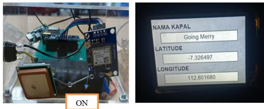
Gambar 3. Pengujian GPS NEO M8N dan Tampilan data yang diterima Receiver
