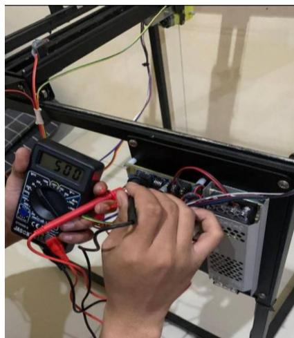
**Gambar 5. Pengujian setelah Di *Step-down***
