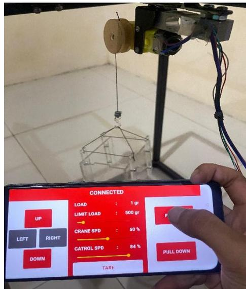
**Gambar 3. Pengujian Katrol dengan Limit Load 10-100 gr**
