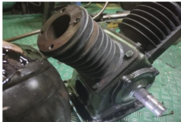
Gambar 9 Korosi di Bagian Rangka Kompresor
