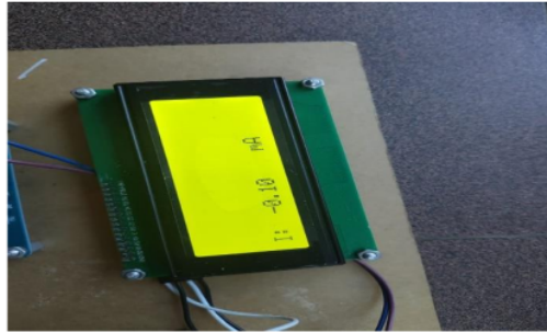
Gambar 4. Pengujian pada Sensor ina219
