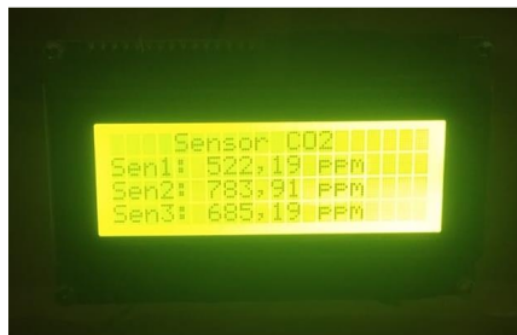
Gambar 8. Pengujian Sensor CO 2 MQ-135 Hasil Deteksi Sensor
