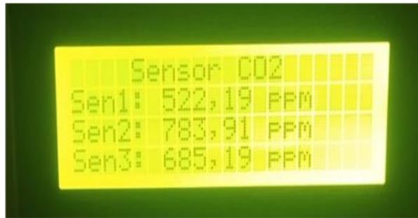
Gambar 18. Liquid Crystal Display menampilkan hasil deteksi sensor
