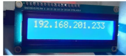
Gambar 4.3 Pengujian LCD 16x2
