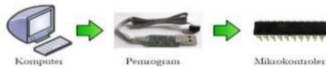
Gambar 11 Penulisan program ke IC mikrokontroler. Sumber : MIKROKONTROLER Konsep Dasar dan Praktis, 2017
