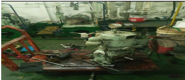
Gambar 5 pembongkaran pompa kompresor pada kapal km.mutiara ferindo 5 di galangan.
