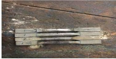
**Gambar 2** Spesimen pertama 140 Ampere
