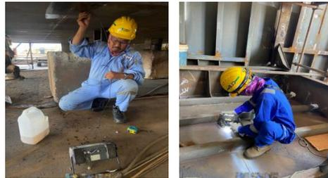
Gambar 15. Seorang technisi UT sebelah kiri dan technisi MT/PT sebelah kanan sedang melakukan pengecheckan cacat pada area yang baru di repair
