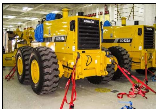
Gambar 1. Pengikatan ( lashing ) kendaraan alat berat
