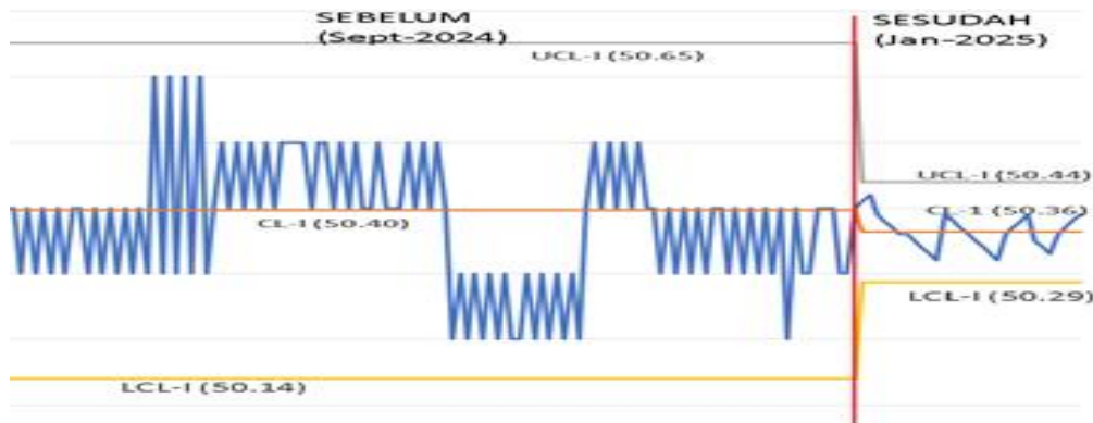
Gambar 5. Perbandingan Peta Kendali Individual Setelah Perbaikan.
