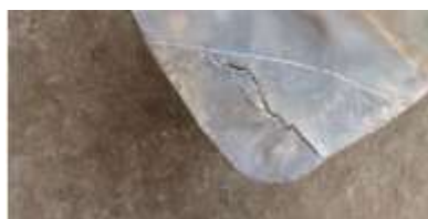
Gambar 4. Keretakan pada Daun Propeller
