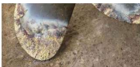
Gambar 3. Erosi pada Daun Propeller
