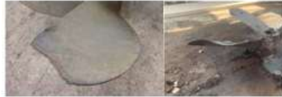
Gambar 5. Patah dan Bending pada Daun Propeller
