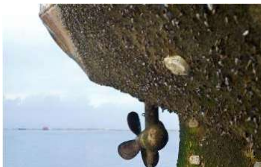
Gambar 2. Fouling yang Menempel pada Propeller
