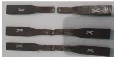
Gambar 7. Spesimen Uji Tarik Las Fcaw- SS Kampuh Double V Setelah Diuji Tarik.
