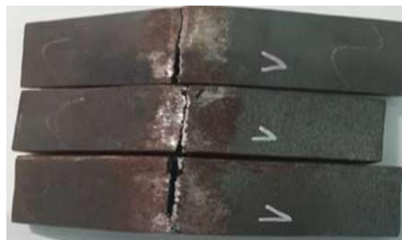
Gambar 10. Spesimen Uji Bending Kampuh Double V Sesudah Diuji Bending.
