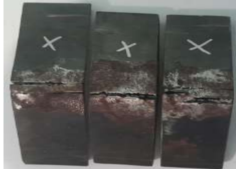
Gambar 9. Spesimen Uji Bending Las FCAW- SS Kampuh V Setelah Diuji Bending.
