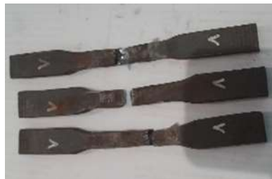
Gambar 5. Spesimen Uji Tarik Las FCAW- SS Kampuh V Sesudah diUji Tarik.
