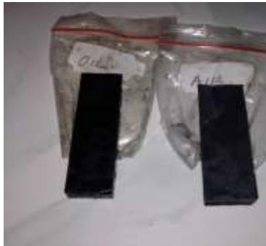
**Gambar 1. Spesimen Hasil Quenching Oli dan Air**
