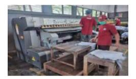
Proses Shaving adalah proses penipisan kulit dengan mesin untuk mendapatkan ketebalan yang di inginkan. Seleksi bahan menjadi tiga bagian.
