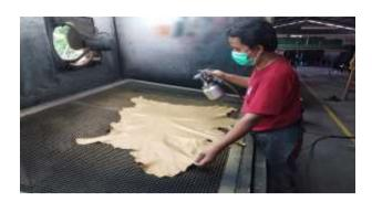
Padding adalah proses pengecatan dasar kulit finish untuk menutup cacat atau kutu. Pisahkan kulit berdasarkan :
