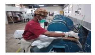
Proses stacking adalah proses pelemasan kulit dengan mesin stacking untuk mengurangi lipatan kulit.
