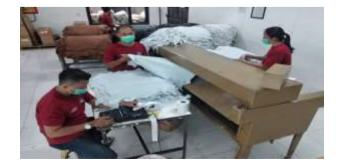
Adalah proses mengukur luas kulit yang sudah jadi. Pada tahap ini pastikan mesin ukur dalam keadaan normal, test dengan kalibrator, Lalu lakukan pengukuran satu – persatu hingga selesai, Masukkan bagian leher lebih dahulu dengan posisi bagian daging di atas, Setelah itu hasil ukur ditempel dengan stiker pada ujung kaki sebelah belakang.
