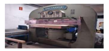
Proses press digital adalah proses pembuatan motif pada nerf dengan menggunakan mesin pres yang menggunakan pemanas.
