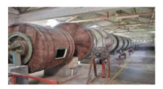
Proses milling adalah proses kulit dimasukkan ke dalam drum dalam keadaan kering tanpa air, di dalam drum diberi beberapa bola karet untuk membenturkan tumpukan kulit supaya menjadi lemas selama 5-10 jam tergantung kondisi kulit.
