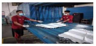
Proses Toggle adalah proses menggunakan mesin yang terdiri atas lembaran plat besi berlubang – lubang untuk mengaitkan toggle clip dan ruangan tempat untuk pemanasan antara 50 – 60oC. proses ini bertujuan untuk mendapatkan luas squarefeet maksimal, kulit dipotong lebih mudah, kulit tidak molor lagi, penampilannya menjadi rapid.
