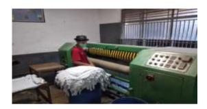
Proses setter adalah proses untuk mengurangi kadar air dalam kulit dan melebarkan permukaan kulit.
